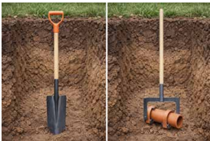
Drainagespade en buizenlegger
